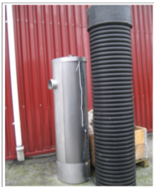
Förslamavskiljaren i svart. Filterenhet i rostfritt med utbytbara absorbenter.
