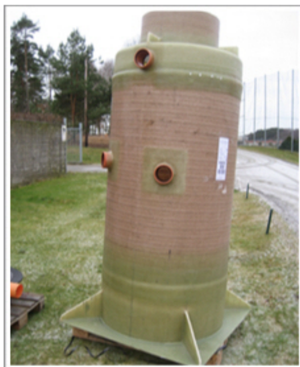
Ny GAP Dn 1000 mm med uppflytnings-skydd för jorduppfyllnad i botten.
